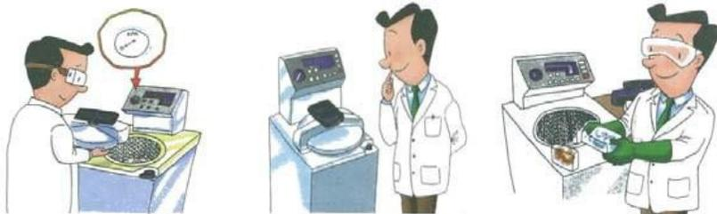
压力恢复正常方可开启    观察是否工作正常    使用隔热手套取物品
