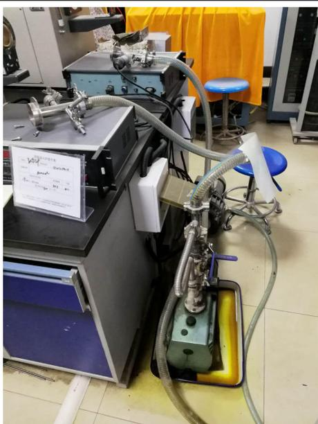
图 1. 格致楼 1031 机械泵漏油较多未清
