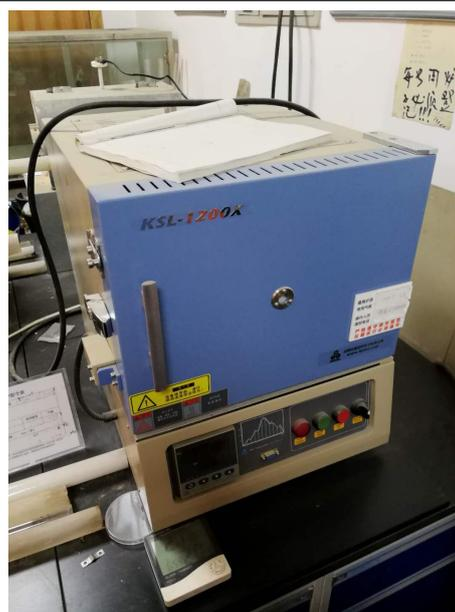
图 2. 格致楼 2027 高温炉上放置可燃物
